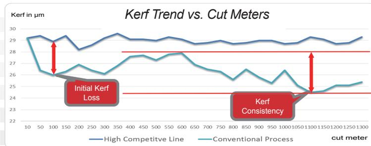
Material: 8" 300μm mirror wafer
